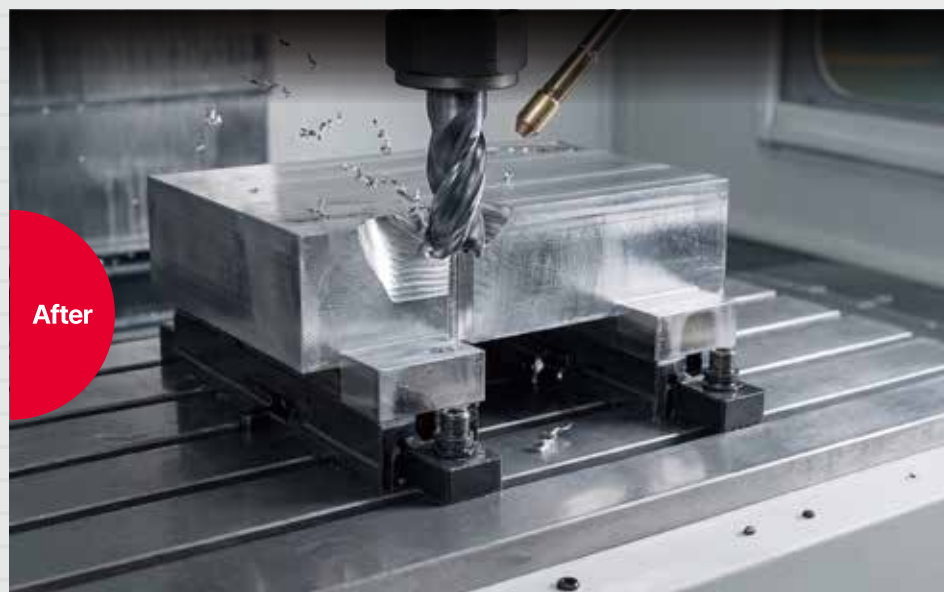
Machining with MQL 미스트장치 설치 후
