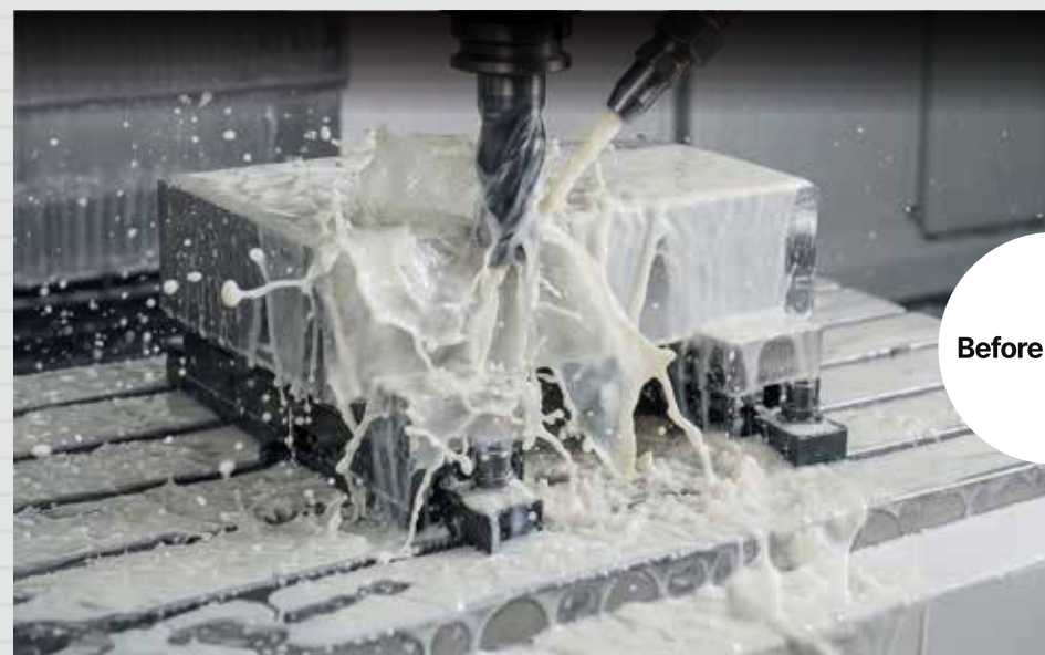
Machining with flood coolant 미스트장치 설치 전
