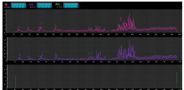
< 용접 불량 발생시 측정 결과 >
