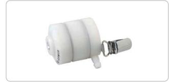
NWPS-35HS SPM & PM2.5 분립 흡인 유량 : 2.5L/min SPM 이상 : 금속 포집판 SPM~PM2.5 : ø20 용지 또는 금속 포집판 PM2.5 이하 : ø35 여과지
