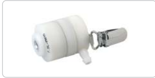
ATPS-20H PM10 & PM 2.5 분립 흡인 유량 : 1.5L/min PM10 이상 : 금속 포집판 PM10~PM2.5 : ø10 용지 또는 금속 포집판 PM2.5 이하 : ø20 여과지
