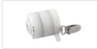
NWPS-35H PM10 & PM 2.5 분립 흡인 유량 : 2.5L/min PM10 이상 : 금속 포집판 PM10~PM2.5 : ø20 용지 또는 금속 포집판 PM2.5 이하 : ø35 여과지
