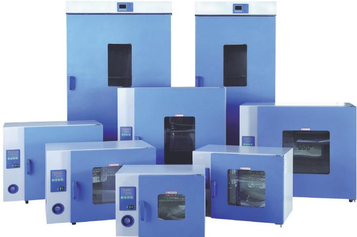
Fan을 이용하여 Heater의 발생 열을 Chamber 내부로 강제 순환시켜서 온도 분포가 양호하여, 시료의 빠른건조가 필요할 때 사용되지만 시료의 표면 온도와 Control 된 Chamber 내부 온도는 다를 수 있다.
