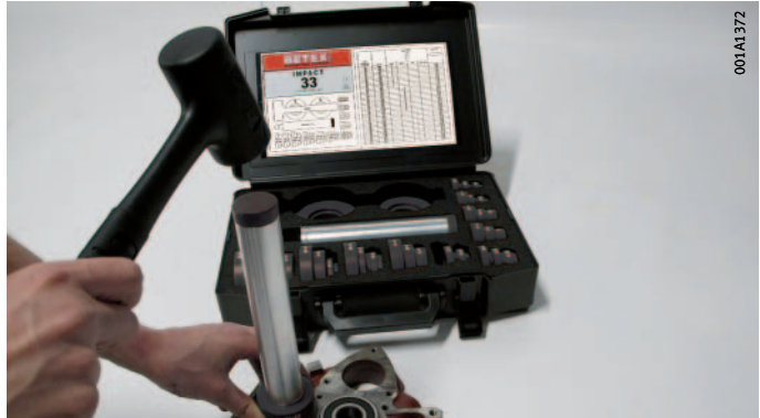
그림 3 해머와 장착 슬리브 세트를 사용한 베어링 설치
