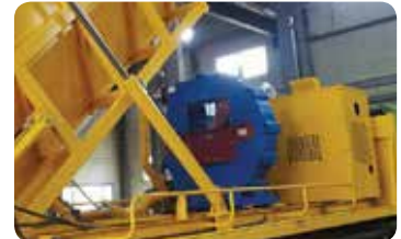
고점도 슬러지의 흡입 및 토출을 위한 대형 펌프 설치(발전기 사용)
