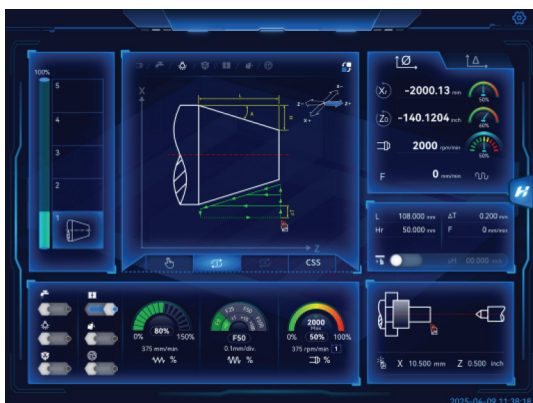
화면 Screen 15인치 컬러 LED 산업용 터치스크린 15" Color LED industrial-grade touch screen
