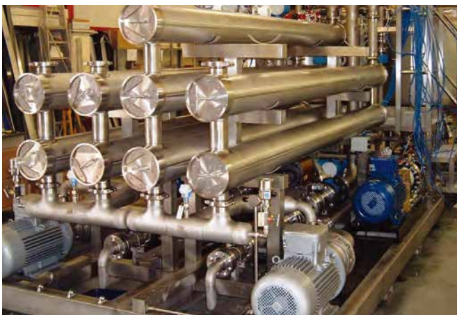
Hydra-Cell 이 제약공장에서 페류 감소 및 염용액 농축을 위해 펌핑하고 있습니다.
