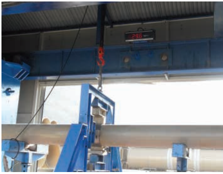
MJL 400A 한국. GRP파이프에 체결 후 수압 시험
