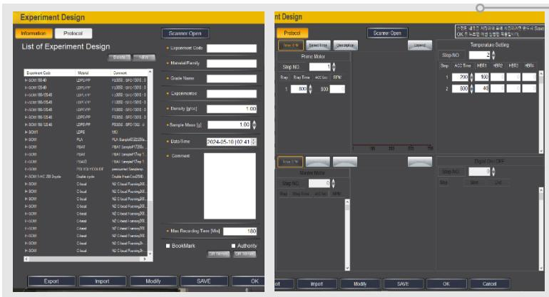
Auto 기능을 활용하여 Protocol을 설정하고 실험이 끝날 때까지 기다리면 됩니다. 시간과 온도만 설정하면, 자동으로 타겟 온도로 도달되기 때문에 별다른 조작 없이 저장된 영상만으로 데이터 분석이 가능합니다.
