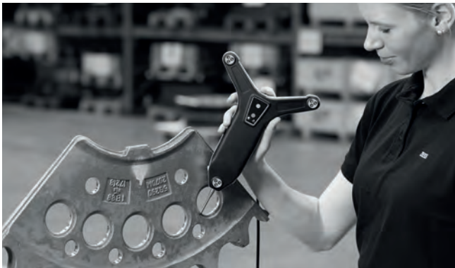
휴대용 터치 프로브 ZEISS T-POINT: 쉬운 싱글 포인트 측정을 위한 이상적인 휴대용 3차원 측정기
