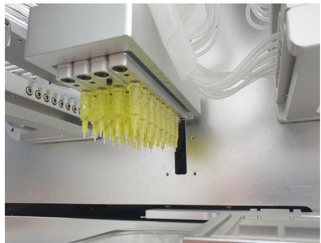
32채널 uL(Micro Liter) 디스펜서는 4가지 시약의 개별/혼합 분주가 가능하고, 유저의 사용환경에 최적화된 기구 구조 및 UI 프로그램을 고객맞춤형으로 제작
