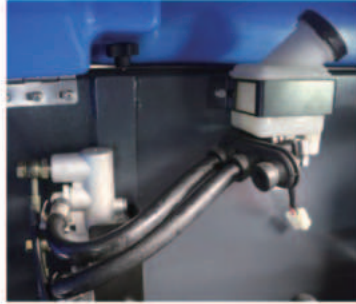
유압식 리어 디스크 브레이크 시스템 : 다양한 종류의 바닥표면에서의 최대한의 안전을 보장합니다.
