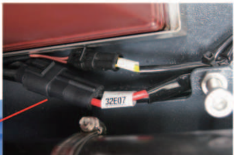
방수처리된 커넥터 및 와이어링 하니스 코딩 시스템
