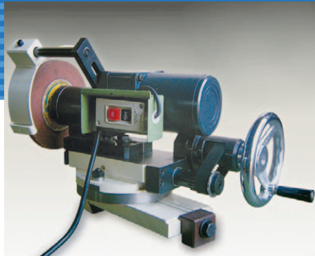
5 다이아몬드휠 자동 각도드레사 장치 (Diamond Wheel Automatic Angle Dresser Att.) 원통연삭기, 공구연삭기, CNC연삭기 등 다이아몬드 휠을 드레싱하는 장치입니다. • 지석 : 180 × 31.75 × 20 t • 모터 : 기어드모터(40w) 인버터 장착
