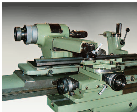
19 헬리칼 연삭장치 (Helical Grinding Att.) 나선형 카터의 경사각, 호브 또는 엔드밀과 센터 드릴의 직선치형 연삭에 능률적이며, 또한 헬리칼 치형의 외부 여유각, 경사각의 연삭작업을 아주 쉽게 할 수 있습니다. • 주축 테이퍼 : MT #4 • 드럼직경 : 34mm • 리이드 : 0 ~ ∞(무한) • 주축 최대회전수 : 5회전 • 최대 연삭직경 : 125mm • 최대 연삭길이 : 320mm • 모듈(호브) : 최대 8 • 헬릭스(호브) : ±8'
