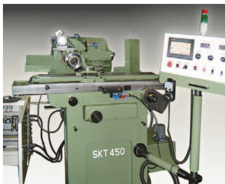
21 2축 전용기(자동 커터) (2 Axis Exclusive Machine) Y축 서보모터 제어(자동 절입 / 이송) X축 인버터 속도제어(자동왕복) A축 인버터 속도제어 장비에 별도의 조작반(터치스크린)으로 X-Y축의 이송 속도 및 절입량 등을 조절합니다. A축(워크헤드)은 작업에 따라 주문제작 가능합니다.
