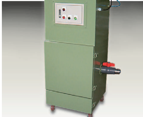
14 집진장치 (Dust Collector) 연삭작업시 발생되는 미세한 금속입자를 흡수하여 기계의 정밀도를 유지하며 또한 작업자의 건강과 쾌적한 작업환경을 위해서도 꼭 필요합니다. • 규격 : 1HP(0.75kw) 2HP(1.5kw) • 풍압 : 200mmAq 250mmAq • 풍량 : 10M³/min 20M³/min • 필터 털기 : 에어 펄스 방식
