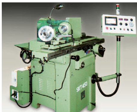
20 2축 전용기(자동 원통) (2 Axis Exclusive Machine) Y축 서보모터 제어(자동 절입 / 이송) X축 인버터 속도제어(자동왕복) A축 인버터 속도제어 장비에 별도의 조작반(터치스크린)으로 X-Y축의 이송 속도 및 절입량 등을 조절합니다. A축(워크헤드)은 작업에 따라 주문제작 가능합니다.
