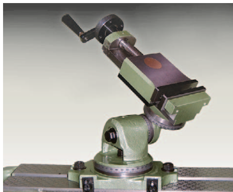
13 3차원바이스연삭장치 (3Axis Vice Grinding Att.) 3차원 바이스로서 평면 연삭은 물론 공구의 끝날 연삭시 편리합니다. 별도의 지지대를 사용하므로 수평, 수직으로 360° 회전이 가능하여 가공물 위치조정이 용이하며 연장주축대와 함께 사용하면 효과적입니다. • 바이스 폭 : 100mm • 깊이 : 25mm • 죠의 최대간격 : 70mm
