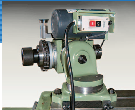
6 소형워크헤드 (II) (Small Workhead Att.) 공구 재연삭 및 소형 공구 연삭에 적합합니다. 모타 장착으로 간편한 원통 작업이 용이 • 모타 : 40w • MT #5
