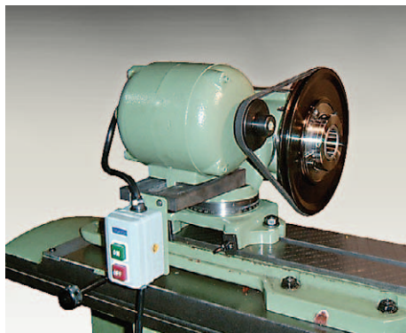
12 원통연삭장치(Cylindrical Grinding Att.) 원통 또는 원통 테이퍼 연삭작업시 사용되며 여러가지 공구의 외경을 연삭할 수 있습니다. 표준 부속품 중 워크헤드에 부착하여 사용합니다. 가공물의 직경이 50mm이상인 경우에는 변속전동 주축대를 사용하는 것이 유리합니다. (위의 그림은 원통 연삭장치와 워크헤드가 조립된 상태임) • 스윙 : 250mm • 회전수 : 340 rpm • 모터 : 0.2kw
