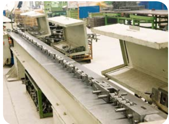
최종 조립 후 사전 부하 작업
