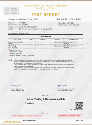
AC2KV 내전압 시험통과 KTR 2018년도 1월 시험
