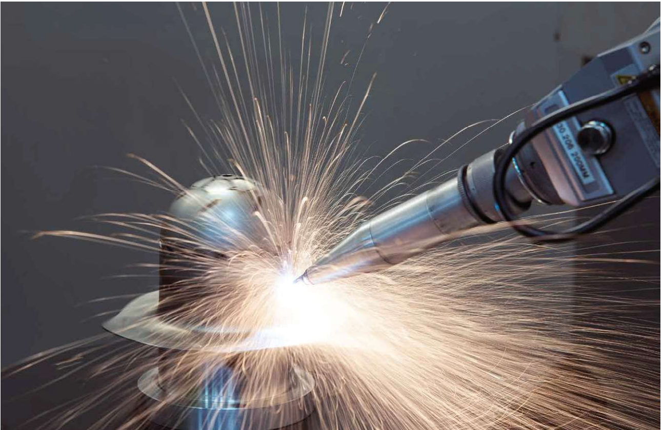
TBC(engineered ceramic) 코팅 표면에 얇은 각도로 0.5mm 지름의 홀 드릴 작업
