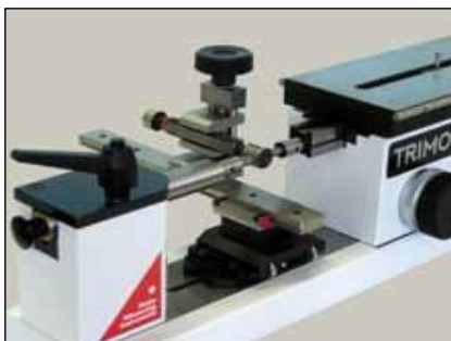
플로팅 테이블을 이용하여 플로그 및 나사 플러그 게이지 교정(THV-115)
