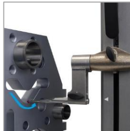
Min / Max 기능을 이용한 가장 낮은점 측정
