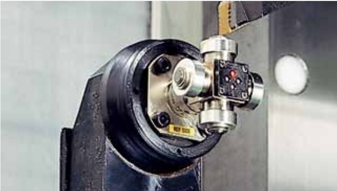
공구 측정 및 마모 등의 감지를 통해 공구 세팅 시간을 크게 줄여줍니다.
