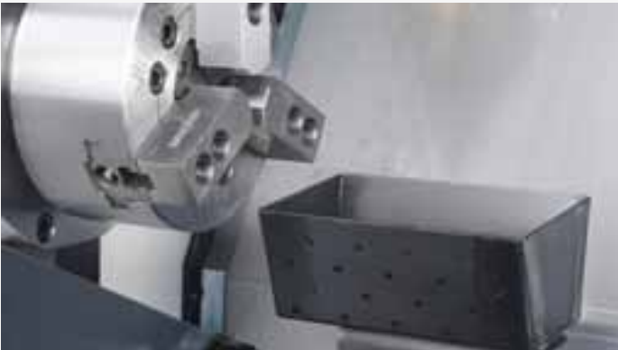
가공이 완료된 부품을 자동으로 받아서 장비 밖으로 배출하는 장치입니다.
